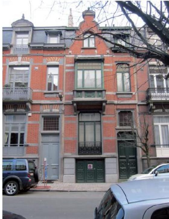
Exemple de façade éclectique jalonnée de ponts thermiques par usage de pierre bleue.
